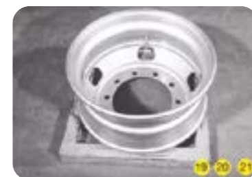
使用安装座另安装更容易进行⑱⑳㉑ 轮盘必须向下, 而气门也须指向地面。
