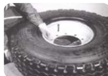
把轮胎完全推上轮辋上, 并确定气门正确的安装在气门嘴槽中。
