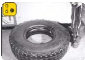
除去气门芯及把内胎充气, 用以分开胎圈(趾口), 按压内胎以挤出困在轮胎与内胎之间的空气, 为气门嘴拧上保护器②
