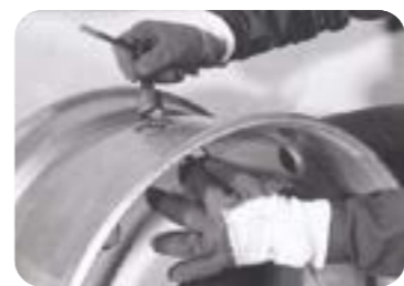
安装气门, 情节金属部分和气门螺纹, 他们应保持良好状态, 安装气门在正确位置, 使用扳手锁紧气门座, 并替固定螺母定位和扭紧。
