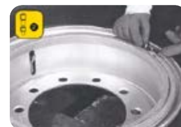
确定所有组成部门均正确安装及相互配合, 如适用可安装安全夹子, 拆除气门上的保护器, 装上气门芯。
