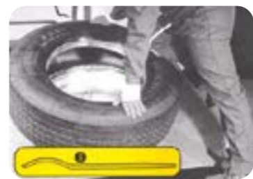
把胎圈(趾口)安装到轮辋的中凹部分, 并与气门相对。按下轮胎使首条胎圈(趾口)滑过法兰圈, 使用膝部直接在轮胎于法兰圈接触点紧紧压下, 最终胎圈(趾口)完全滑进法兰圈, 如有困难, 可使用撬棍。
