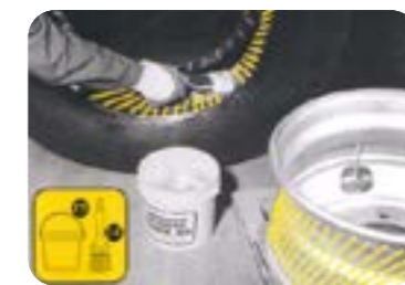
使用润滑油来润滑轮辋的内侧, 润滑胎圈(趾口)的安装范围和胎圈(趾口)的内侧部。
