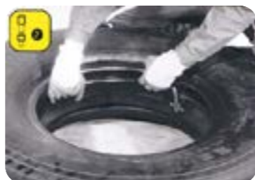
拆除气门嘴保护器②, 再次检查垫带的位置。
