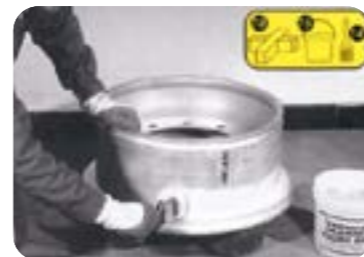
把车轮放在安装木座上, 轮辋, 使用润滑油润滑轮辋胎座部位。
